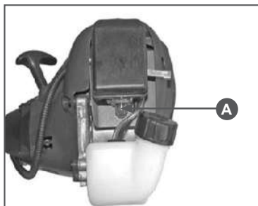
Рис. 8 Насос ручной топливный
