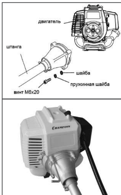
Рис. 5 Соединение двигателя и штанги
