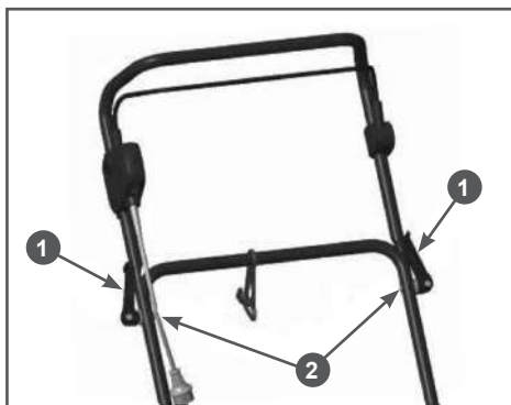
Рис. 5 Соединение верхней и нижней части рабочей рукоятки
