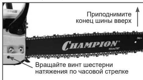
Рис. 5 Регулировка натяжения цепи
