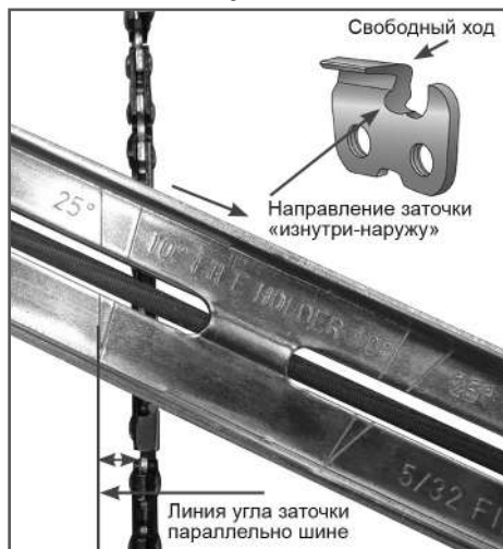
Рис. 24 Расположение линии угла заточки
