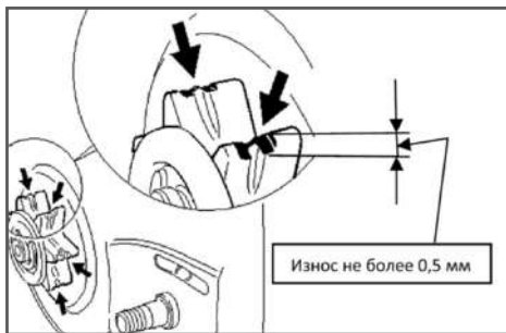
Рис. 14 Проверка износа звездочки
