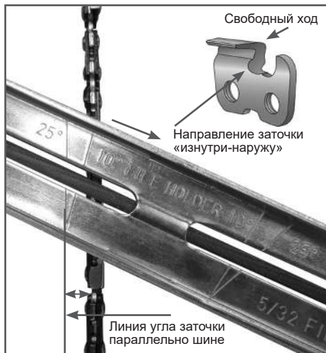
Рис. 16 Определение угла заточки
