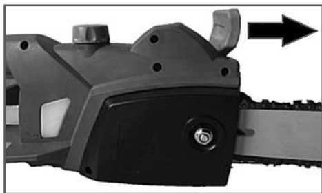
Рис. 8 Включение тормоза цепи
