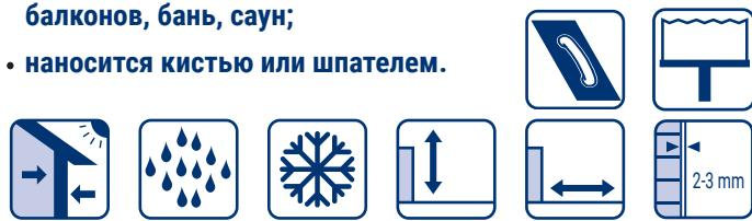
элементов, подверженных разрушению при контакте с водой - гипсокартонных плит, гипсовых блоков, блоков из ячеистого бетона и т.д. Применяется для гидроизоляции соединений стен и пола, деформационных швов, мест ввода водопроводной и канализационной систем, электрических кабелей и установочных мест освещения.
