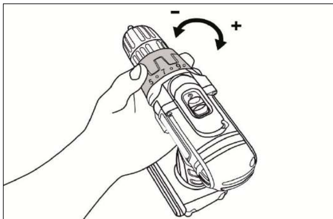
Рис. 10 Установка крутящего момента
